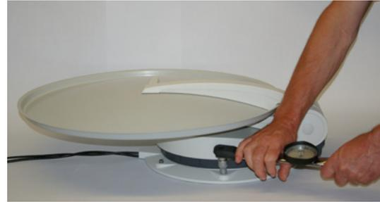
9. Dreheinheit mit einem Drehmoment-Schlüssel wieder auf die Montageplatte schrauben.
